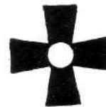
Fig. 12.6. Punct de triangulație pe biserică
