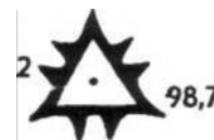
Fig. 12.4. Punct de triangulație pe movilă
